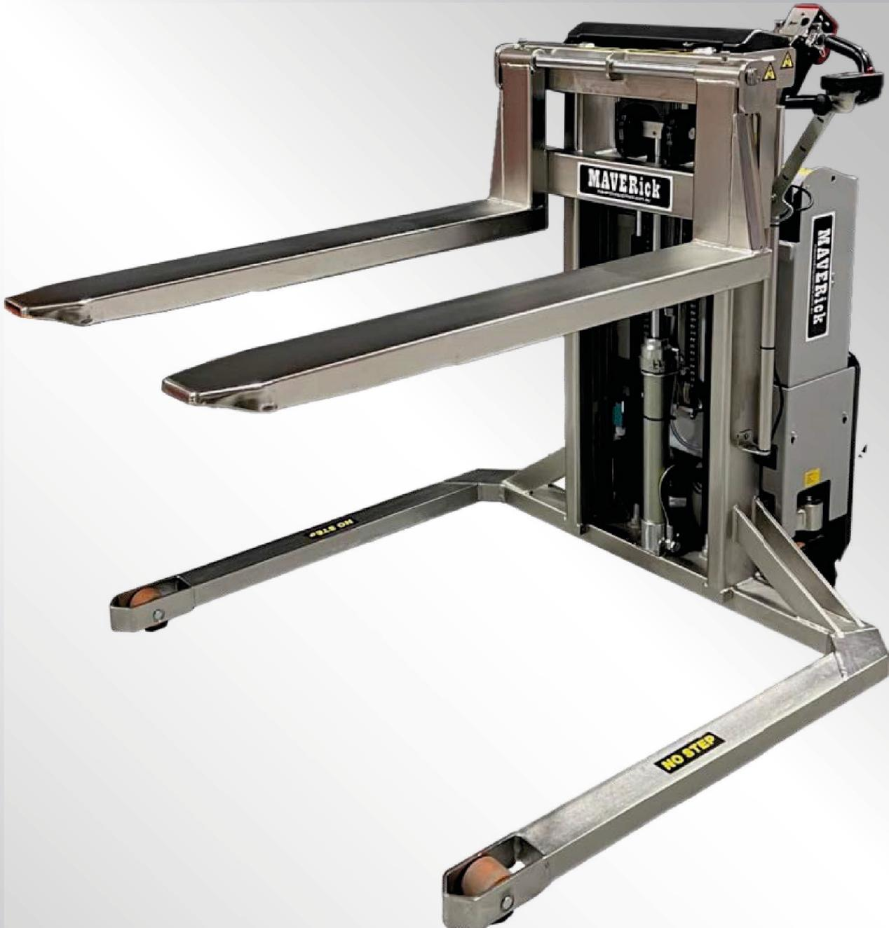
Ein Edelstahl Stapler, der den Mitarbeitern bei dem Pharma-Unternehmen, CSL Behring, einen guten ergonomischen Arbeitsplatz bietet. Der Stapler wird im Reinraum eingesetzt, wo Paletten automatisch auf eine ergonomische Arbeitshöhe gehoben/gesenkt werden, um diese zu entleeren oder zu beladen.
